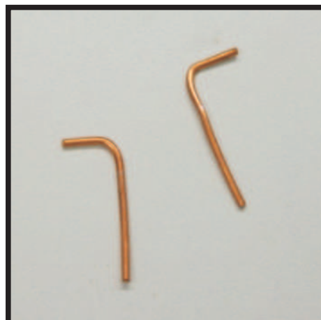
Aansluitdraden maken van 1,5mm 2 instalatie draad
