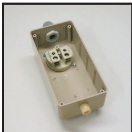
Stopkontakt en trekcontlastingen aanbrengen
