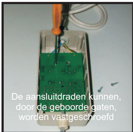
Sluit de snoeren aan op de afgemonteerde print en schuif de print in het kastje
