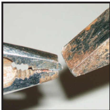
Het onderleg plaatje aan de rand ombuigen alvorens de print hiermee vast te klemmen
