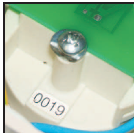
Het onderleg plaatje aan de rand ombuigen alvorens de print hiermee vast te klemmen
